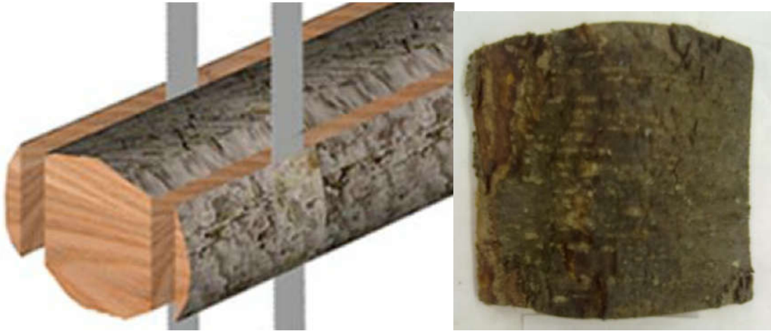
2. kép: Kalapdeszka típusú mintadarab
