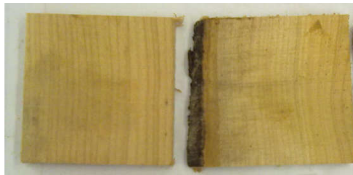
3. kép: Kétféle, húrmetszet típusú mintadarab
