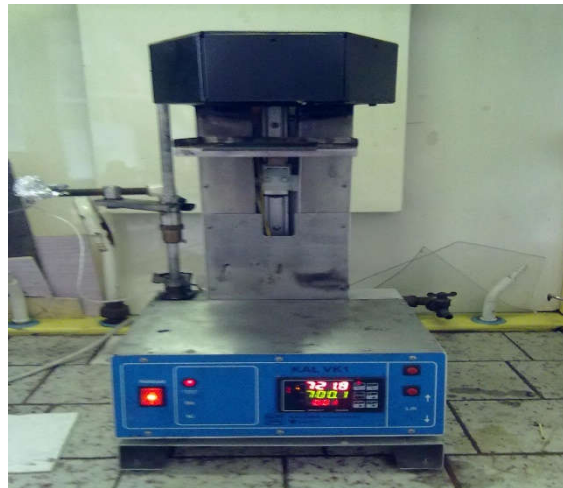
11. kép: KAL VK 1 műszer elvi felépítése és műszer felfűtése a kísérlet előtt
