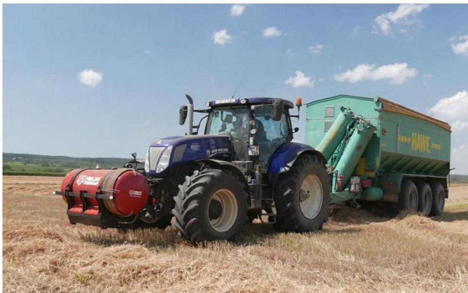
4. ábra: A Fields Fireman által fejlesztett oltóberendezés. [8]
